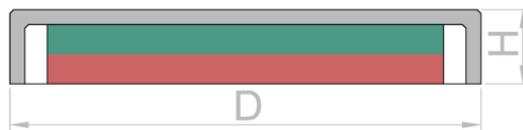
Scherkraft: Die angegebene Haftkraft wurde rechtwinklig zum Haftgrund gemessen. Um den Magneten seitlich zu verschieben, ist eine viel kleinere Kraft notwendig. Wenn Sie einen Topfmagneten also an einer Wand verwenden, können Sie ihn deutlich weniger belasten, als wenn Sie ihn an der Decke einsetzen.
