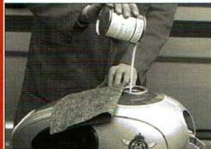
Das angemischte Tanksiegel vollständig in den Tank füllen. Lackierte Flächen mit Lappen schützen.
