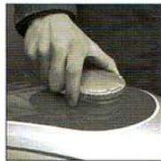
Tank mit altem Deckel verschließen. Oder: Plastikfolie zwischen Deckel und Einfüllöffnung legen.
