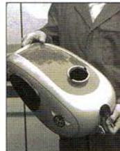
Tankdeckel entfernen, Tank solange drehen u. wenden, bis Tanksiegel nicht mehr fließt.
