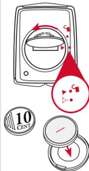
Setzen Sie nun den Batteriedeckel mit der Batterie in das Batteriefach im Computer ein.
